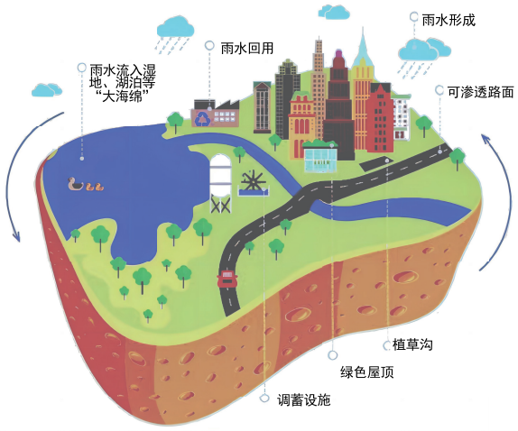
图2 海绵城市结构示意图
